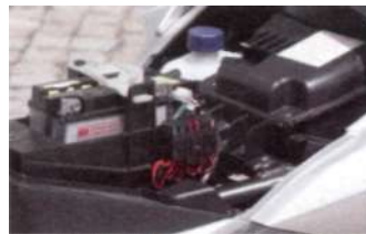
Unter dem Fahrersitz frei zugänglich ist die Batterie
